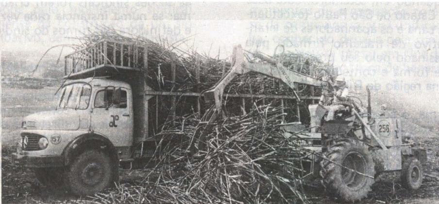
A mecanização do embarque está sendo ampliada para o corte
